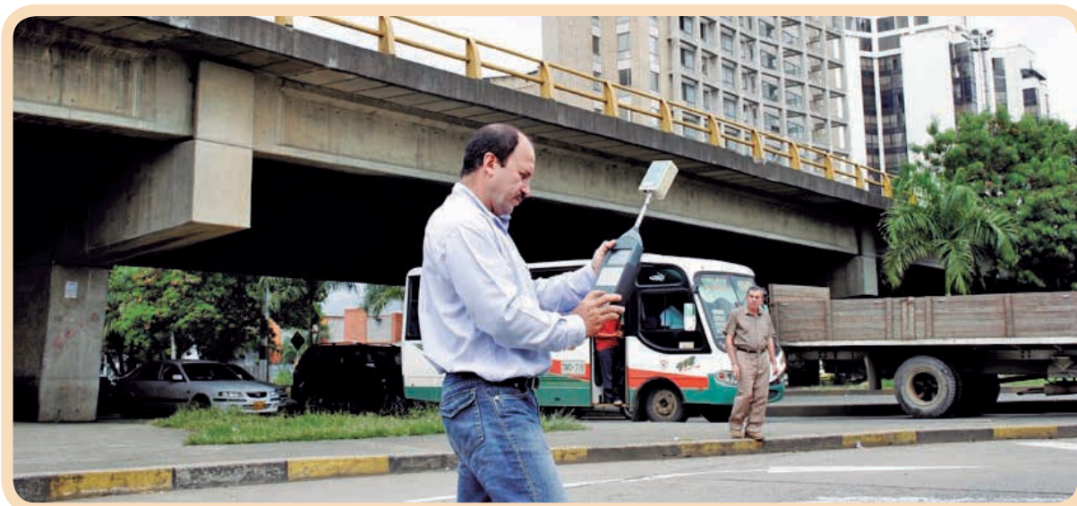
Foto 6. Medición para el control de contaminación por ruido
